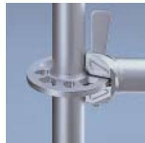
*Aufbauschnelligkeit ist eingebaut: Die 4 schmalen Ausstattungen zentrieren den Riegel automatisch im rechten Winkel – die 4 breiten Ausstattungen erlauben das Ausrichten von Riegel und Diagonale auf den jeweils geforderten Winkel.*
