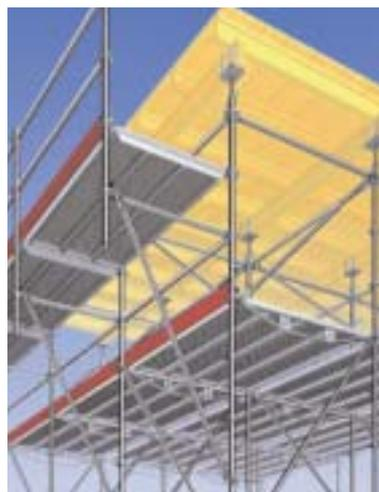
Konsolen, nach Bedarf, sind mit Systemteilen schnell angebaut; der Lochscheiben-Abstand von 50 cm gibt immer die optimale Arbeitshöhe.
