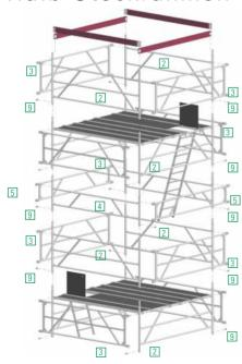
Es müssen beim Aufbau und Abbau Systembeläge oder Gerüstbohlen nach DIN 4420 (Mindestabmessung: 28 x 4,5 x 350 cm lang) als Hilfsbeläge im Höhenabstand von max. 2,0 m eingebaut werden. Diese Hilfsbeläge, als sichere Standfläche für den Auf- und Abbau, müssen nach dem Aufbau wieder ausgebaut werden. Die jeweilige Standfläche ist voll auszulegen.
