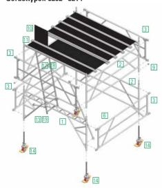
Bei den Gerüsttypen 8202 – 8214 können verschiedene Einstiegrahmen 1 1,95 m/2,8 m, Steckrahmen 2 1,95 x m/2,8 m und Aussteifer 3 1,95 x 2,8 m eingebaut werden. Diese Fahrgerüste sind in ihrer Plattformgröße unterschiedlich (siehe Aufbaubeispiele auf Seite 2). Zunächst wird ein Einstiegsrahmen 1 und ein Steckrahmen 2 mit zwei Aussteifern 3 verbunden. Dies geschieht durch das Einrasten der Einrastklauen in den Steckrahmen 1 und den Einstiegsrahmen 1.
