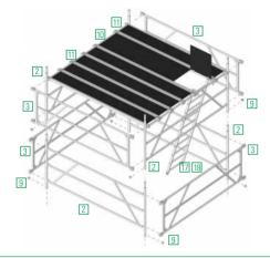
Es müssen beim Aufbau und Abbau Systembeläge oder Gerüstbohlen nach DIN 4420 (Mindestabmessung: 28 x 4,5 x 350 cm lang) als Hilfsbeläge im Höhenabstand von max. 2,0 m eingebaut werden. Diese Hilfsbeläge, als sichere Standfläche für den Auf- und Abbau, müssen nach dem Aufbau wieder ausgebaut werden. Die jeweilige Standfläche ist voll auszulegen.
