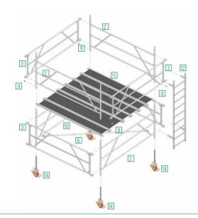
Der Gerüsttyp 8201 hat eine Plattformgröße von 2,8 x 2,8 m und wird mit Steckrahmen 2,8 m und Aussteifern 2,8 m aufgebaut.
