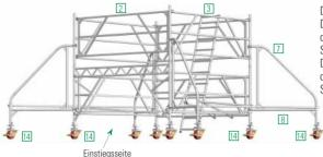
Die Ausleger an den Steckrahmen einstecken und durch Festdrehen der Flügelschrauben an den Spindelmuttern gegen Herausfallen sichern.
